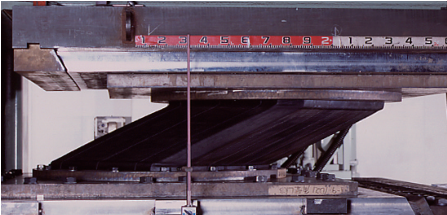
LRS-S (角型) : 350%大変形性能確認試験
